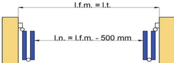
Sezione orizzontale applicazione ante e colonnine in luce con apertura a 90°
