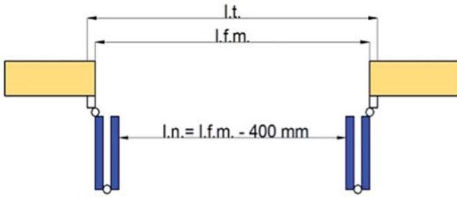
Sezione orizzontale: applicazione colonnine oltre luce ed ante in luce con apertura a 90°
