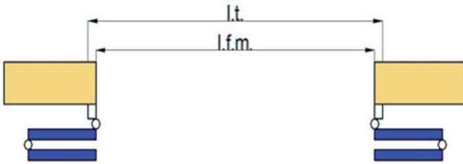
Sezione orizzontale applicazione ante e colonnine oltre luce con apertura a 180°
