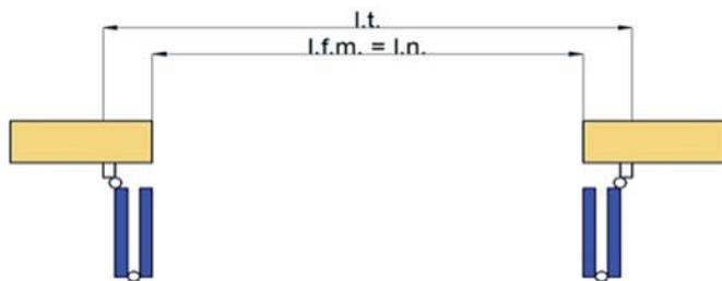
Sezione orizzontale applicazione ante e colonnine oltre luce con apertura a 90°
